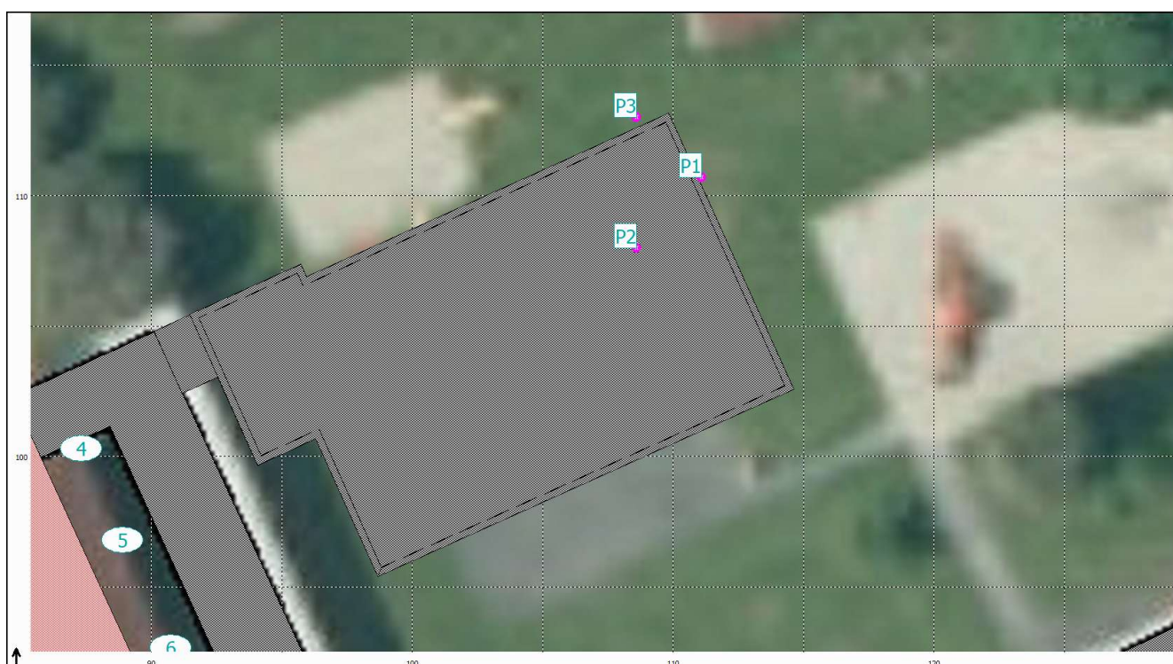
Obrázek 1: 2D výpočtový model – zobrazení posuzovaných zdrojů hluku
